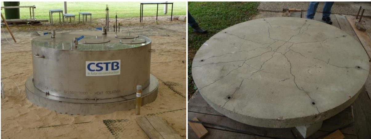
**FIGURE 1 : DISPOSITIF DES ESSAIS DE TRANSFERT DE TCE VERS L'AIR INTERIEUR D'UN CAISSON (MARZOUGUI, 2013)**
