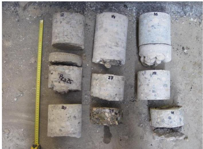
Figure 9 : Réalisation des carottages de dalle et obtention de neuf carottes de béton.
