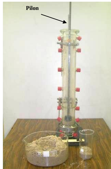
Fig.A. 6 : Profil de saturation en eau - 2 ème série de test, et remplissage de la colonne de sable humide
